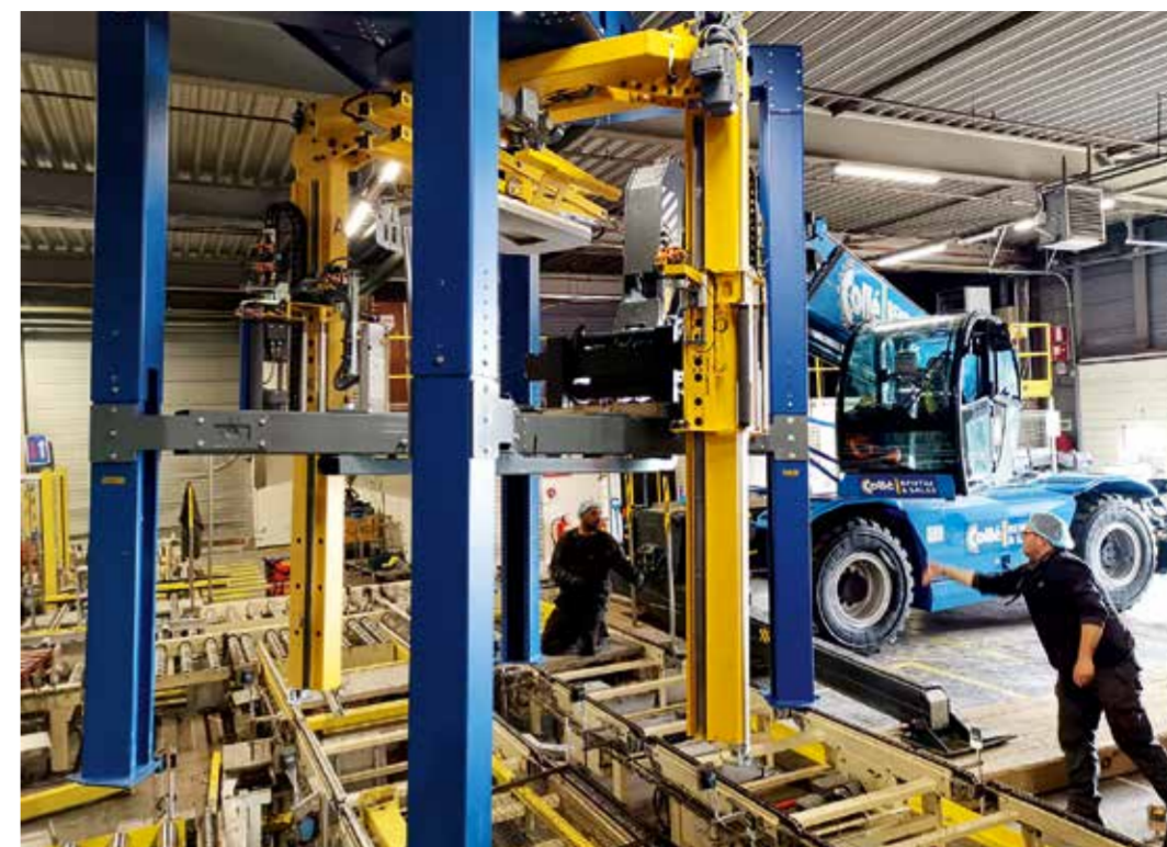
Een speciale zware verrijker zette de 4,5 ton wegende machine vijftig meter verder op zijn plaats.
